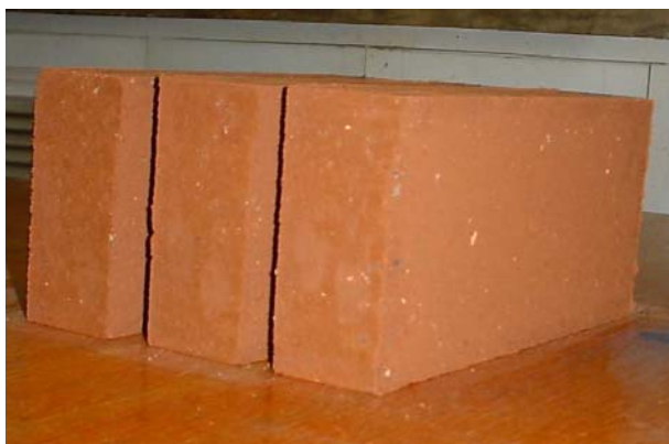
Figura 1 – Tijolos de solo-cimento produzidos com ARC.
